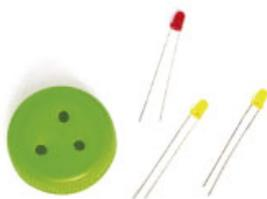
2. Mete cada led en los orificios desde la parte exterior de la tapa. Colócalos de tal manera que la pata larga de un led (polo positivo) quede junto a la pata corta (polo negativo) del siguiente led y así sucesivamente.
