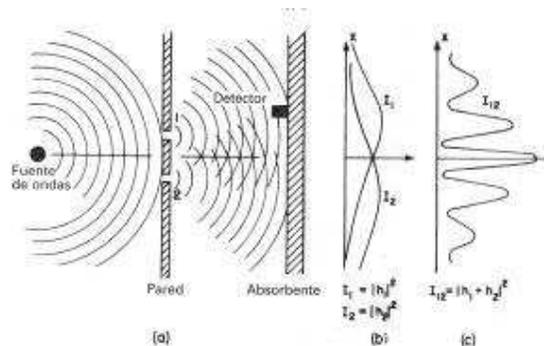
6.3 Experimento de interferencia con ondas de agua.
