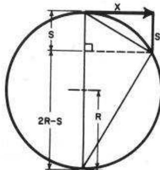
5.5 Aceleración hacia el centro de una trayectoria circular. De la geometría plana,  $x/s = (2R - S)/x = 2R/x$ , donde  $R$  es el radio de la Tierra, 6.400 kilómetros;  $x$  es la distancia «recorrida horizontalmente» en un segundo; y  $S$  es la distancia «caída» en un segundo (4,9 metros).
