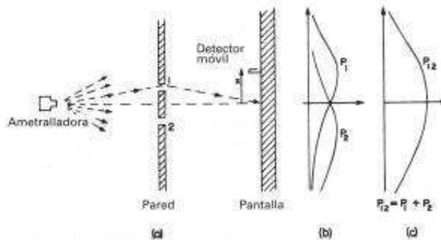
6.1 Experimento de interferencia con balas.
