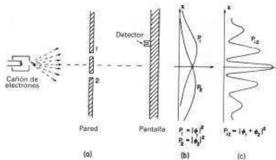
6.7 Experimento de interferencia con electrones.
