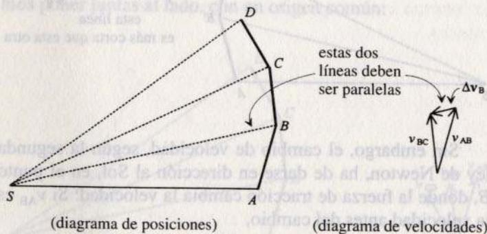
El cambio de velocidad en el punto  $B$ ,  $\Delta v_B$ , se hace pues en la dirección de la tracción solar y es además proporcional a la magnitud de la fuerza. Si la tracción solar fuera el doble de fuerte en el punto  $B$ ,  $\Delta v_B$  sería dos veces mayor. Tal es el significado de la segunda ley de Newton. El cambio de velo-
