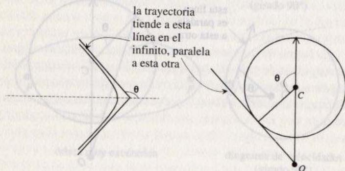
En esta trayectoria, el «planeta» cae hacia el Sol desde el infinito, da una vuelta alrededor suyo y huye otra vez hacia el infinito. Esta trayectoria no es en realidad una órbita. Cuando parte del infinito y cuando vuelve, su velocidad no es cero; la velocidad es proporcional a la longitud de la línea que va de  $O$  al punto de tangencia con el círculo de velocidades.
