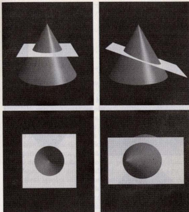
Izquierda: El plano corta el cono y origina un círculo visto desde arriba (abajo). Derecha: El plano inclinado corta el cono y origina una elipse vista desde arriba (abajo).
