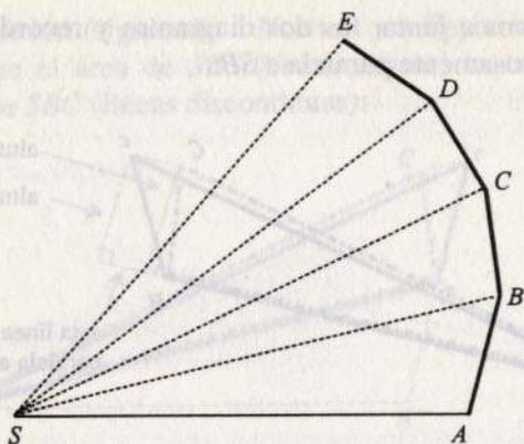
salta a la vista que podríamos aplicar los mismos argumentos a los triángulos siguientes,  $SCD$ ,  $SDE$ , etc. Son los triángulos barridos por el planeta en tiempos iguales. De este modo hemos probado la segunda ley kepleriana del movimiento planetario: que un planeta barre áreas iguales en tiempos iguales.
