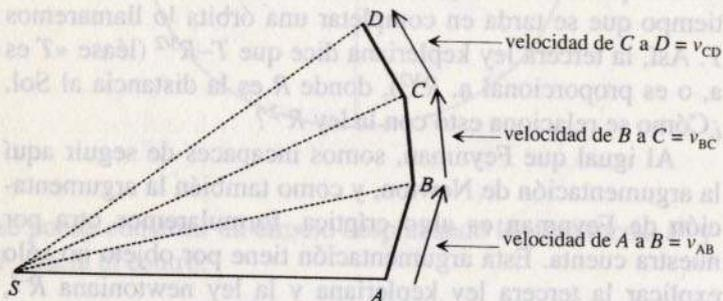
No hay razón para que las flechas de la velocidad se tracen junto al correspondiente segmento de la órbita; las podemos poner juntas al lado, con un origen común:
