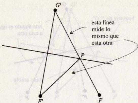
A causa de la congruencia de los triángulos, la longitud  $F'P$  es la misma que la longitud  $G'P$ . De aquí se sigue que la distancia de  $F'$  a  $P$  y de aquí a  $F$  es la misma que la de la recta  $FG'$ . Pero dicha distancia no es más que la longitud del cordel que utilizamos para trazar la elipse del principio. En otras palabras, si trazamos una elipse con el método del cordel,  $G'$  será el punto al que llegaremos estirando el cordel.
