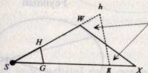
Hemos trazado la línea hg, paralela a HG, de manera que estos dos triángulos tengan áreas iguales
