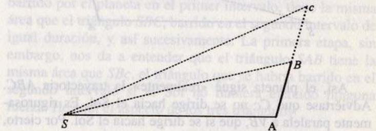
Sin embargo, la fuerza del Sol (que se ejerce de manera continua) se representa mediante un impulso ejercido en el punto  $B$ , que se traduce en un componente de movimiento dirigido hacia el Sol,  $BV$ :
