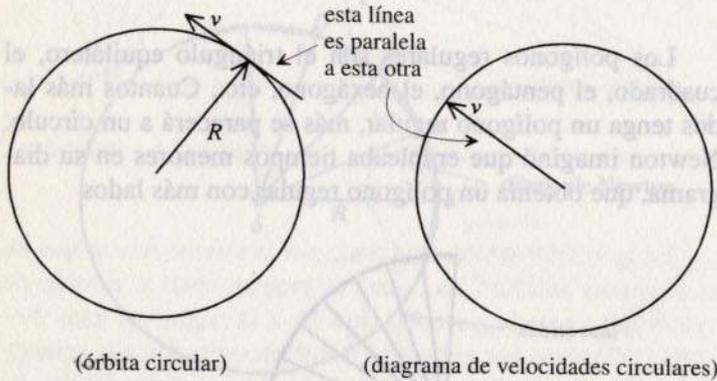
El radio del círculo, en el diagrama de velocidades, es  $v$ , la rapidez uniforme del planeta en toda la órbita. Esta rapidez viene dada por la distancia que recorre el planeta dividida por el tiempo que tarda. La distancia recorrida por el planeta es la longitud de la circunferencia orbital, es decir,  $2\pi R$ , y el tiempo que tarda el planeta en recorrerla es lo que hemos llamado  $T$ , el periodo de la órbita. Por lo tanto,  $v$  es igual a  $2\pi R/T$ .
