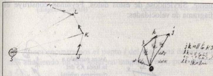
La órbita parte de la posición  $J$ , sigue hasta  $K$  formando un ángulo con el Sol, sufre un  $\Delta v$  que cambia su dirección, luego continúa, formando un ángulo idéntico, de  $K$  a  $L$ , y a continuación de  $L$  a  $M$ :
