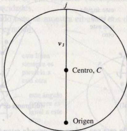
Trazada así,  $v_j$  es vertical (paralela a la  $v_j$  del diagrama orbital) y es la distancia más larga entre el origen y un punto del círculo. La velocidad en el punto  $p$  del diagrama de velocidades, correspondiente al punto  $P$  del diagrama orbital, es una línea que sale del origen y es paralela a  $v_p$ :
