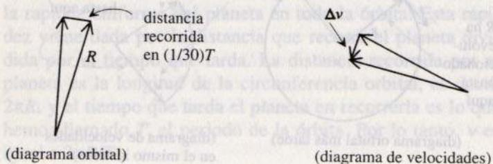
La fuerza, como hemos visto, es proporcional a  $\Delta v/\Delta t$ , donde  $\Delta v$  es el cambio de velocidad, igual a  $1/30$  del perímetro del círculo de velocidades, y  $\Delta t$  el tiempo empleado,  $1/30$  de  $T$ . Evidentemente,  $1/30$  del perímetro dividido por  $1/30$  del tiempo es lo mismo que dividir todo el perímetro por todo el tiempo. Así,  $\Delta v/\Delta t$  es igual al perímetro (o circunferencia, es decir,  $2\pi v$ ) dividido por el tiempo  $T$ .
