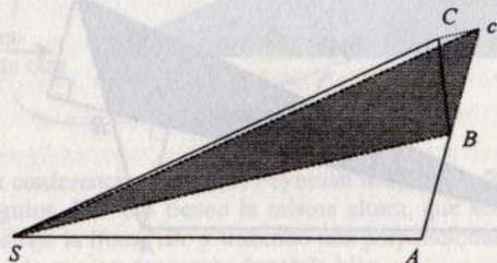
El área de un triángulo es igual a la mitad de su base por su altura. Una forma de averiguar el área del triángulo  $SAB$  sería tomar  $SA$  por base, en cuyo caso la altura sería la perpendicular que podría trazarse entre la prolongación de  $SA$  y el punto más alto del triángulo:
