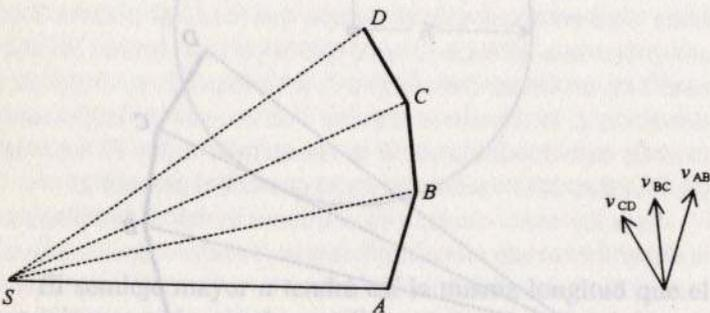
El nuevo diagrama es un diagrama de velocidades y no de posiciones. La dirección de la flecha señala la dirección del movimiento del planeta, de modo que  $v_{AB}$  tiene que ser paralela a  $AB$ ,
