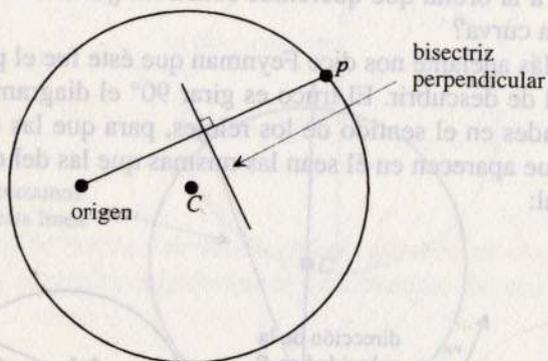
Como es perpendicular a la línea del origen a  $p$ , sabemos que es paralela a  $v_p$ , la velocidad en el punto  $P$  de la órbita. En determinado punto, la bisectriz corta la línea que une  $P$  con el centro  $C$ :
