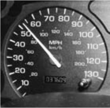
FIGURA 2-8 Velocímetro de un automóvil que muestra las mi/h en números grandes, y los km/h en números pequeños.
