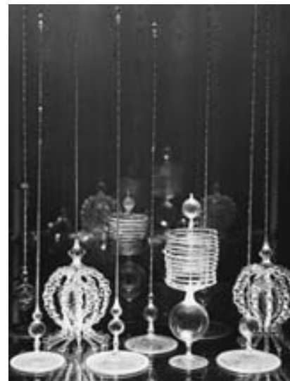
FIGURA 17-4 Los termómetros fabricados por la Accademia del Cimento (1657-1667) en Florencia, Italia, están entre los primeros conocidos. Estos sensibles y exquisitos instrumentos contenían alcohol, a veces coloreado, como muchos termómetros actuales.
