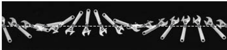
FIGURA 9-22 Traslación más rotación: Una llave inglesa que se mueve libremente sobre una superficie horizontal. El CM, marcado con una cruz, se mueve en línea recta.
