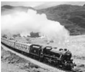
FIGURA 8-15 Al quemarse el combustible (una reacción química) se libera energía para hervir agua en esta locomotora. El vapor producido se expande contra un pistón que efectúa trabajo al mover las ruedas.
