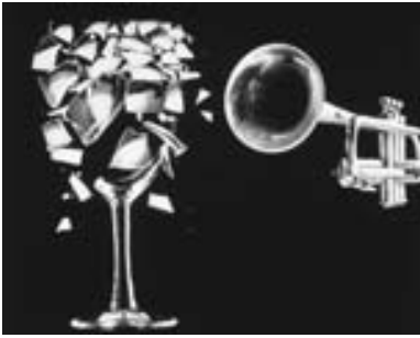
FIGURA 14-24 Esta copa se rompe al vibrar en resonancia con el sonido de la trompeta.
