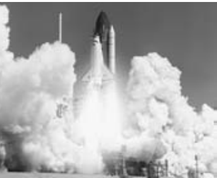
FIGURA 4-10 Otro ejemplo de la tercera ley de Newton: el lanzamiento de un cohete. El motor de un cohete empuja los gases hacia abajo, y éstos ejercen una fuerza igual y opuesta hacia arriba sobre el cohete, de modo que lo aceleran hacia arriba. (Un cohete no acelera como resultado de los gases expulsados que empujan contra el suelo).
