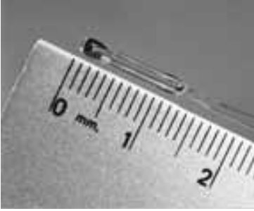
FIGURA 25-15 Se muestra un resistor térmico junto a una regla en milímetros, como referencia.
