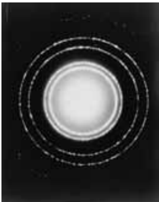
FIGURA 37-11 Patrón de difracción de electrones dispersados de una hoja de aluminio, registrado en película.
