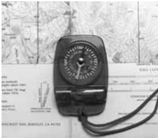
FIGURA 27-6 Uso de un mapa y una brújula en el campo. Se alinea primero la aguja de la brújula de manera que apunte alejándose del norte verdadero (N) tantos grados como lo señale la declinación registrada en el mapa (15° para el lugar mostrado en este mapa topográfico de una parte de California). Luego se alinea el mapa con el norte verdadero, pero no con la aguja de la brújula, como se observa en la fotografía.
