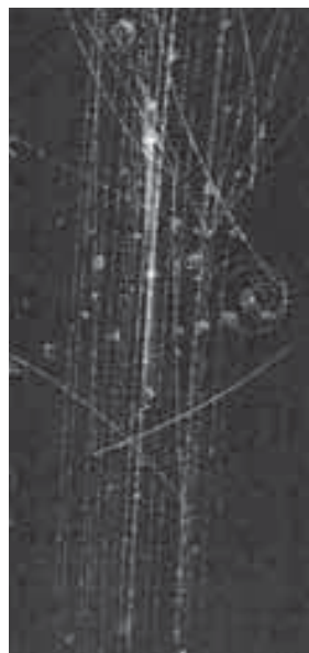
FIGURA 43-12 Fotografía de una cámara de burbujas de hidrógeno líquido de un antiprotón ( \bar{p} ) que choca con un protón en reposo, lo que produce un par Xi-anti Xi ( \bar{p} + p \rightarrow \Xi^- + \Xi^+ ) el cual posteriormente decae en otras partículas. El dibujo indica la asignación de partículas a cada trayectoria, que se basa en cómo decae esa partícula o si decae, y en los valores de masa estimados a partir de la medición de la cantidad de movimiento (curvatura de la trayectoria en el campo magnético) y la energía (grosor de la trayectoria, por ejemplo). Las trayectorias de las partículas neutras se muestran mediante líneas punteadas, pues las partículas neutras no producen burbujas y, en consecuencia, tampoco trayectorias.
