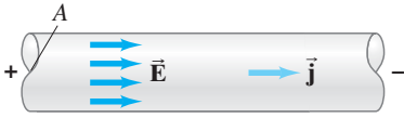
FIGURA 25-24 Campo eléctrico \vec{E} en un alambre uniforme de sección transversal de área A que transporta una corriente I . La densidad de corriente es j = I/A .
