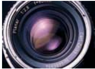
FIGURA 34-22 Lente recubierta. Note el color de la luz reflejada de la superficie frontal de la lente. (Véase el pliego a color al final del libro).
