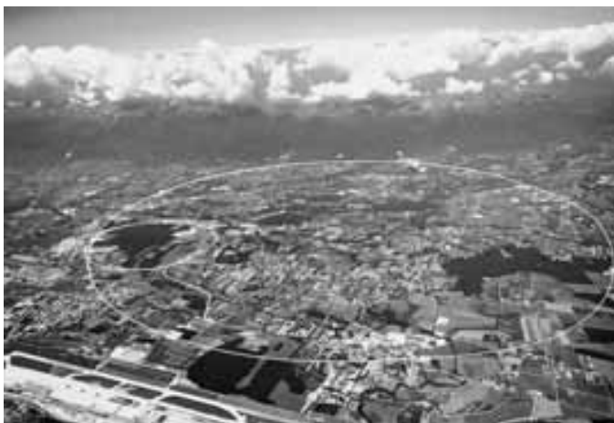
FIGURA 43-5 El círculo grande representa la posición del túnel, aproximadamente 100 m bajo el suelo en el CERN (cerca de Ginebra) en la frontera franco-suiza, que alberga al LHC. El círculo más pequeño indica la posición del Super Proton Synchrotron (supersincrotrón de protones) que se usará para acelerar protones antes de inyectarlos en el LHC.
