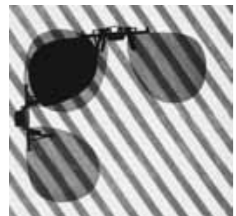
FIGURA 35-37 Polaroid cruzados. Cuando las lentes polarizadas de las dos gafas se traslapan, con ejes perpendiculares, casi no pasa luz a través de ellas.
