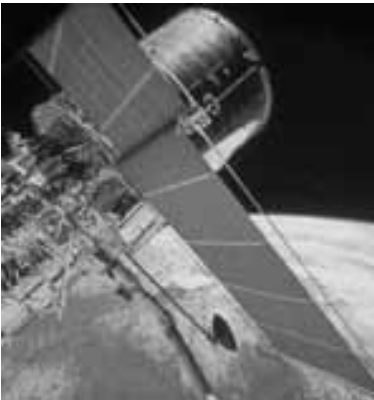
FIGURA 35-15 El Telescopio Espacial Hubble, con la Tierra como fondo. Los enormes paneles planos son celdas solares que colectan energía proveniente del Sol.
