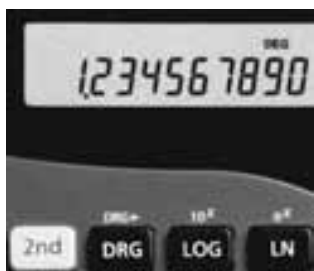
FIGURA 35-45 Pantalla LCD de calculadora. A los segmentos o píxeles negros se les aplica un voltaje. Note que el 8 utiliza los siete segmentos (píxeles), mientras que otros números usan menos.
