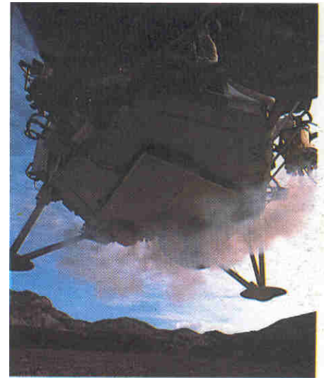
Aterrizaje en el Valle de la Muerte, California, simulando el del Viking en Marte. Las últimas fases del descenso son frenadas por el encendido de los retrocohetes. (Fotografía. Bill Ray. )
