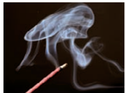
12.20 El flujo de humo que sale de estas varas de incienso es laminar hasta cierto punto; luego se vuelve turbulento.
