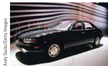
Figura 14.13 Flujo laminar alrededor de un automóvil en un túnel de viento.
