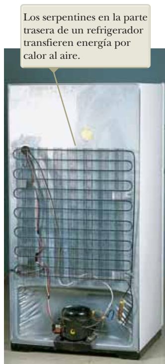
Figura 21.6 Parte posterior de un refrigerador casero. El aire que rodea los serpentines es el depósito caliente.
