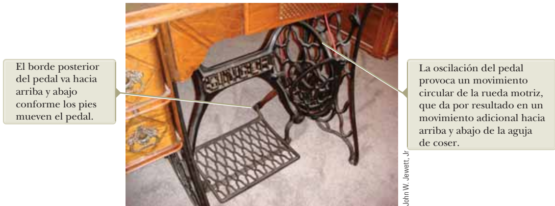
Figura 15.12 La parte inferior de una máquina de coser de pedal, de principios del siglo xx. El pedal es ancho y plano con rejillas metálicas.
