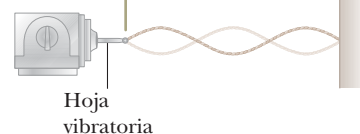
Figura 17.16 En una cuerda se establecen ondas estacionarias cuando un extremo se conecta a una hoja vibrante.
