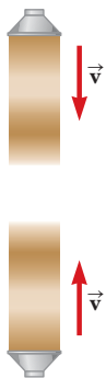
Figura 17.6 Dos bocinas idénticas emiten ondas sonoras una hacia otra. Cuando se traslapan, las ondas idénticas que viajan en direcciones opuestas se combinarán para formar ondas estacionarias.
