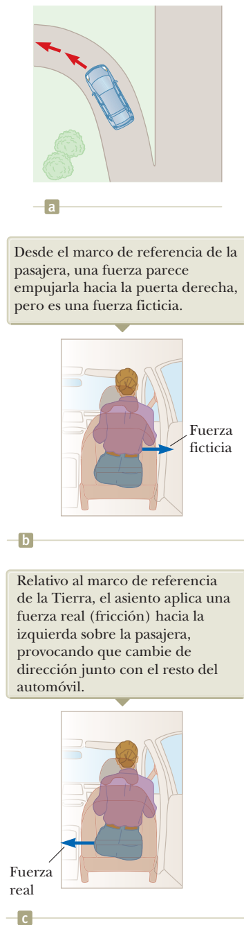
Figura 6.10 (a) Un automóvil se aproxima a una rampa de salida curva. ¿Qué hace que una pasajera en el asiento de adelante se mueva hacia la puerta derecha? (b) Desde el marco de referencia de la pasajera. (c) En relación con el marco de referencia de la Tierra.
