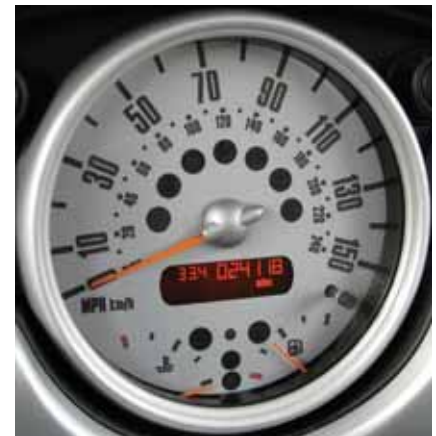
Figura 1.6 Indicador de velocidad de un vehículo que muestra magnitudes de velocidad tanto en millas por hora como en kilómetros por hora.
