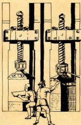
Antigua máquina agrícola utilizada para formar balas de paja comprimida.
