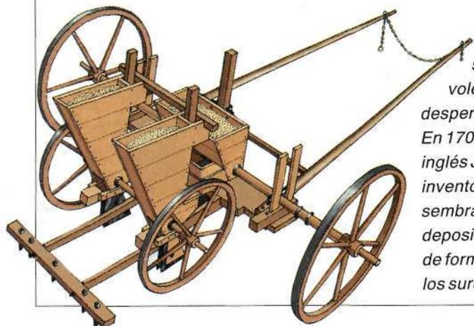
◀ La siembra a voleo era un desperdicio enorme. En 1701, el agricultor inglés Jethro Tull inventó una máquina sembradora que depositaba las semillas de forma uniforme en los surcos.
