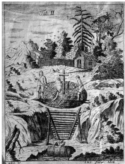
39 Line drawing of tar production in Pohjanmaa (Österbotten), Finland. Copper engraving, I.H.S. From Carl Fredrik Mennander & Eric Juvelius, Tiärtlwärcckningen i Österbotn , 1747, Åbo (1752).
